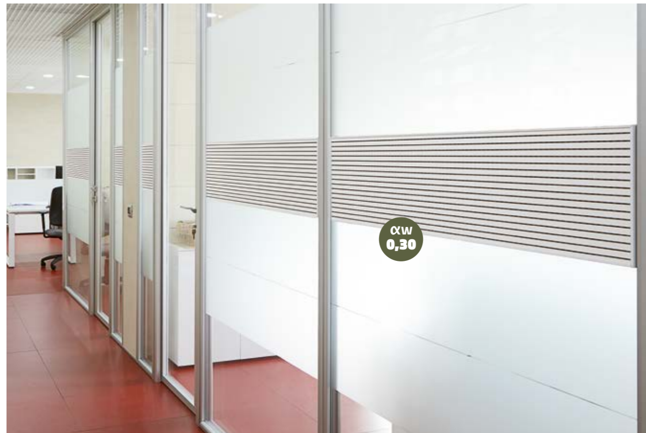
WALL SOUND ABSORPTION SOUND WOOD PANEL · WHITE · CW3216 · w=0,50 · CW3232 · \alpha_w=0,30
